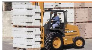
Con la carga elevada, inclinar el mástil hacia delante únicamente para depositar la carga en la estantería o pila. Para retirar la carga, inclinar el mástil lo justo necesario para estabilizar la carga sobre las horquillas. En ambos casos accionar los mandos con suavidad.
